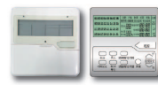
液晶顯示集中控制器 可由一台液晶顯示集中控制器，控制8台、 16台、32 台室內機板，內含功能：模式、 風量、溫度、定時開關機、自動掃描、總 開機、總關機、單向控制、雙向控制、站 台功能。
